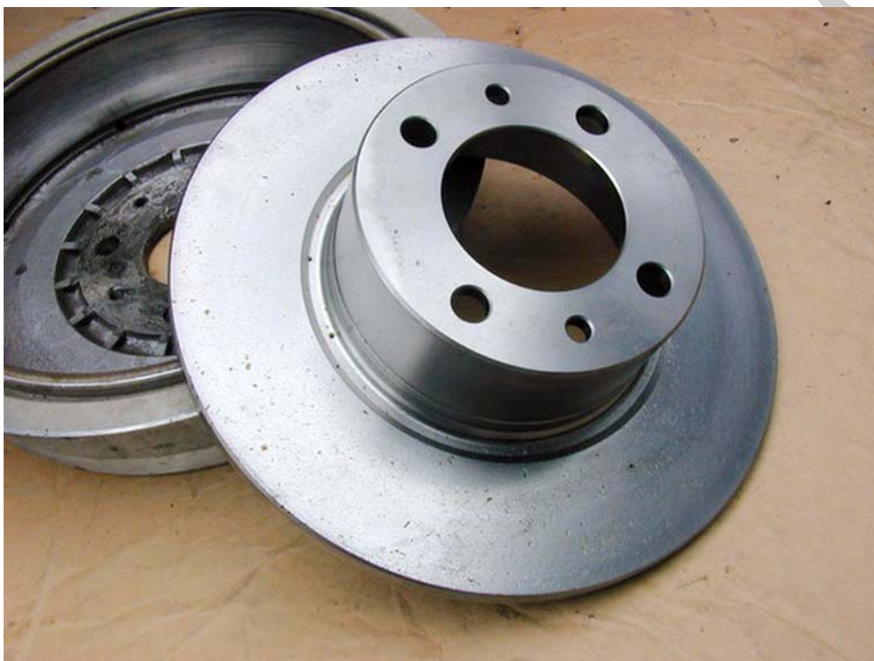
15. ábra. Felszerelés után az új féktárcsát és fékdobot zsírtalanítani kell
