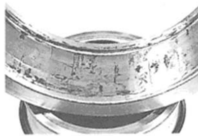
24. ábra. Korrodált felület
