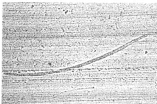
23. ábra. Karc a csapágy felületén
