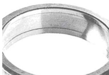
22. ábra. Befeszült felület
