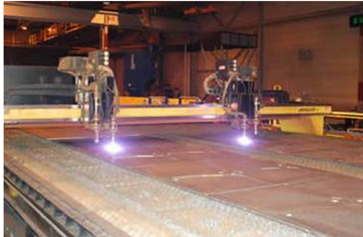
27. ábra. Gépi lángvágó berendezés működés közben
