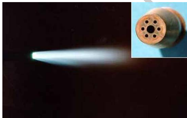
4. ábra. Acetilén láng, és a hozzá való fúvóka kialakítás
