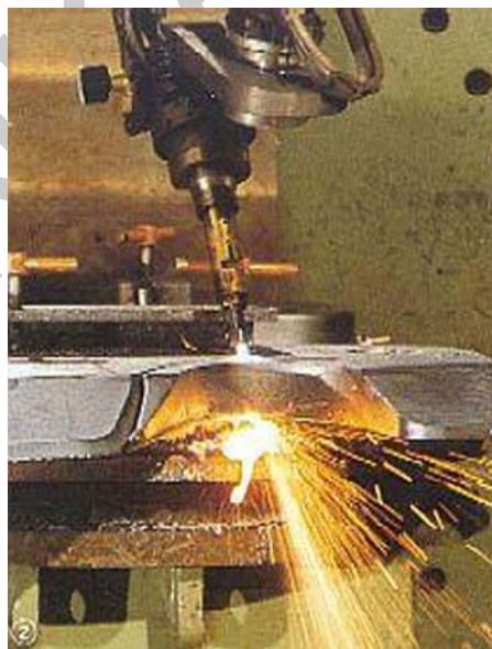
1. ábra. A lángvágás folyamata
