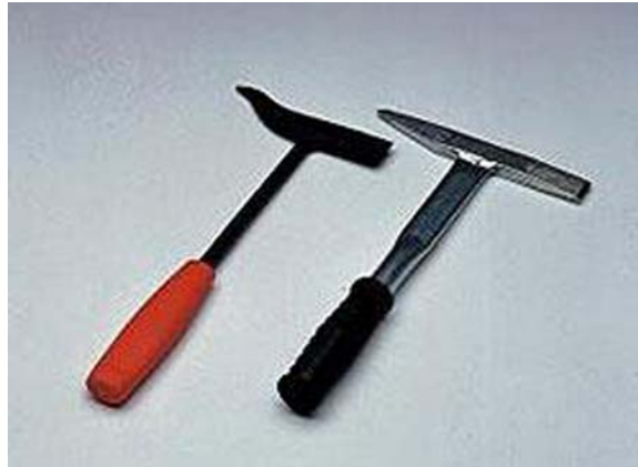
23. ábra. Salakoló kalapácsok (Felesleges varratrészek eltávolítására)
