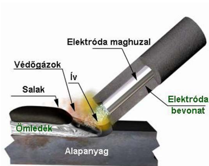
3.ábra. Kézi ívhegesztés vázlata
