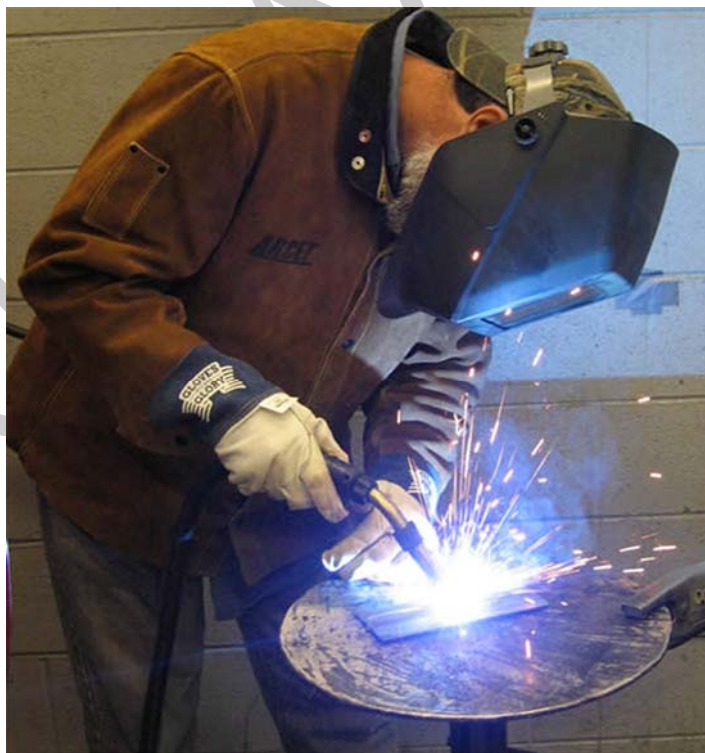
1.ábra. Az ívhegesztés munkafolyamata
