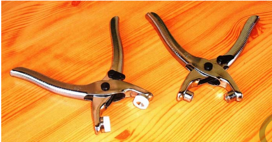
18. ábra. Csőszegecs fogók
