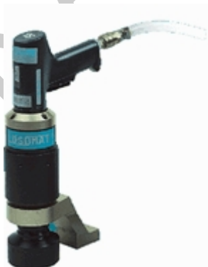
17. ábra. Pneumatikus nyomatékkulcs 10
