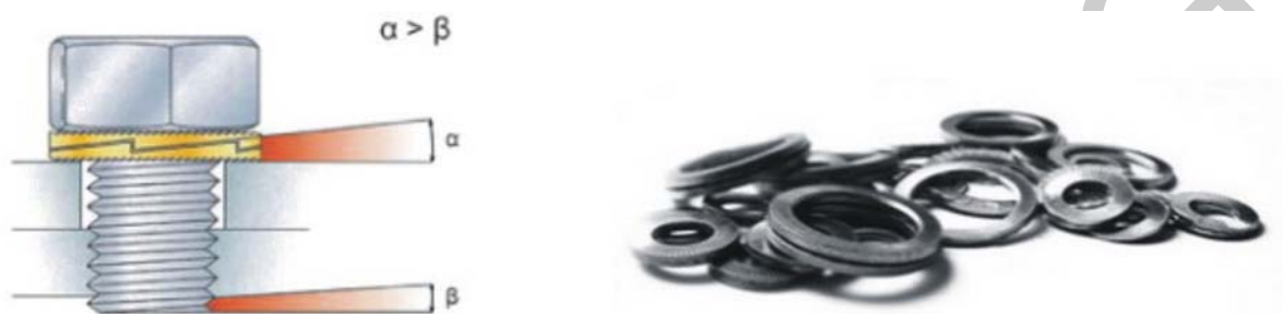
13. ábra. Csavarbiztosítás zárófogazással készült alátéttel
