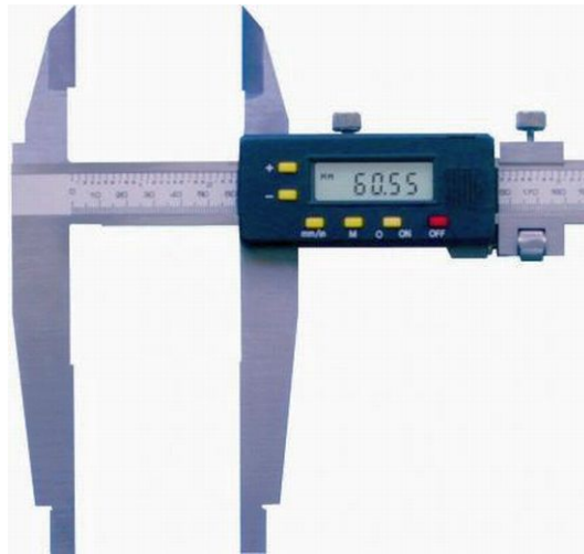
8. ábra: Mérőcsőrös finombeállítós digitális tolómérő
