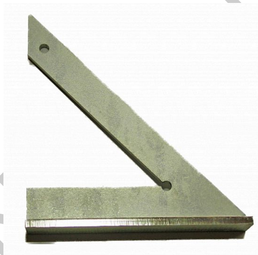
35. ábra: 45^\circ ellenőrzésére szögidomszer
