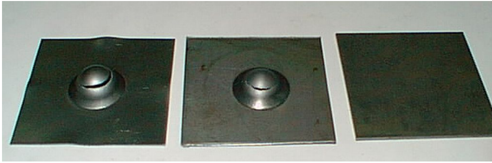
35. ábra: Mélyhúzó vizsgálat eredménye
