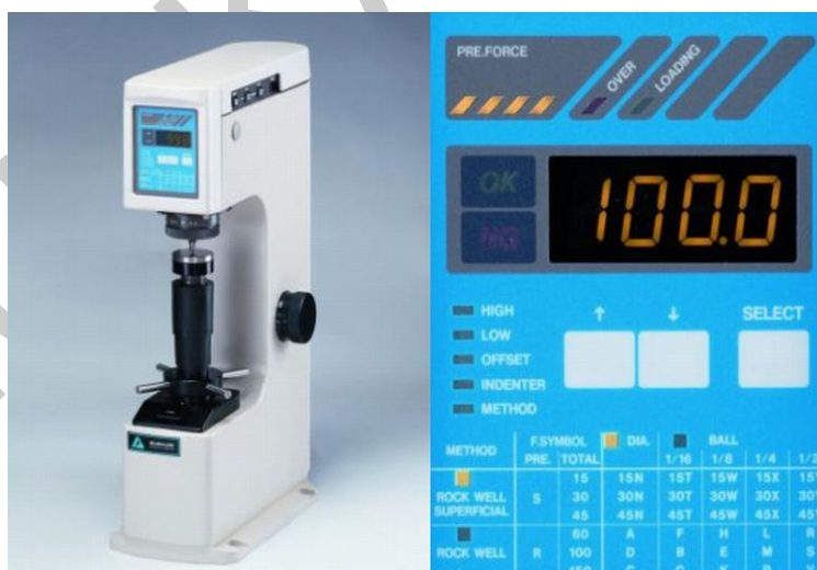
24. ábra: Hagyományos Rockwell-gép és kezelő felülete
