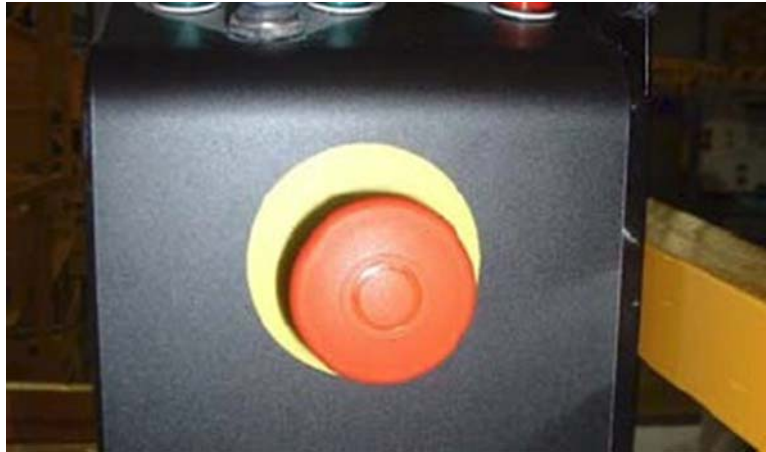
10. ábra. Mozgó munkaállvány kezelőpult vészleállító gombja 10
