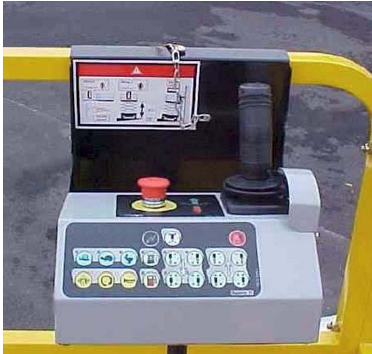
9. ábra. Mozdó munkaállvány kezelőpultja 9
