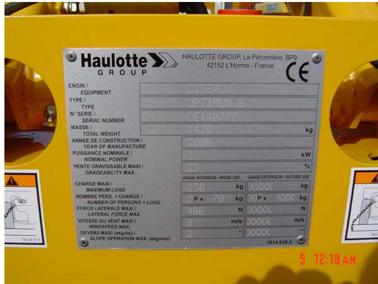
13. ábra. Mozgó munkaállvány adattáblája 13
