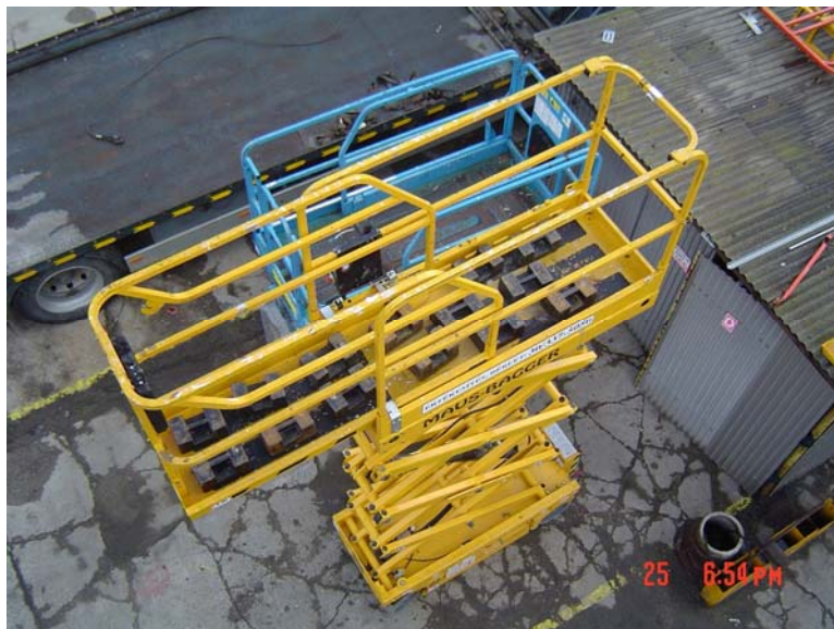
24. ábra. Munkaállvány fővizsgálata – teherpróba 24
