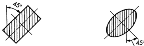
17. ábra. 45°-os kontúrokkal, illetve középvonallal rendelkező alkatrészek vonalkázása
