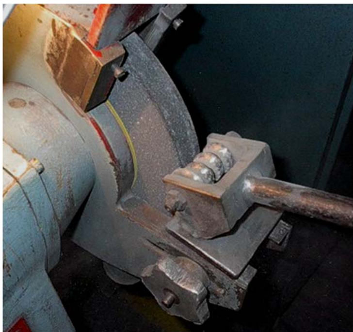
Korongszabályozás csillag szabályozóval (durva szabályozás)
