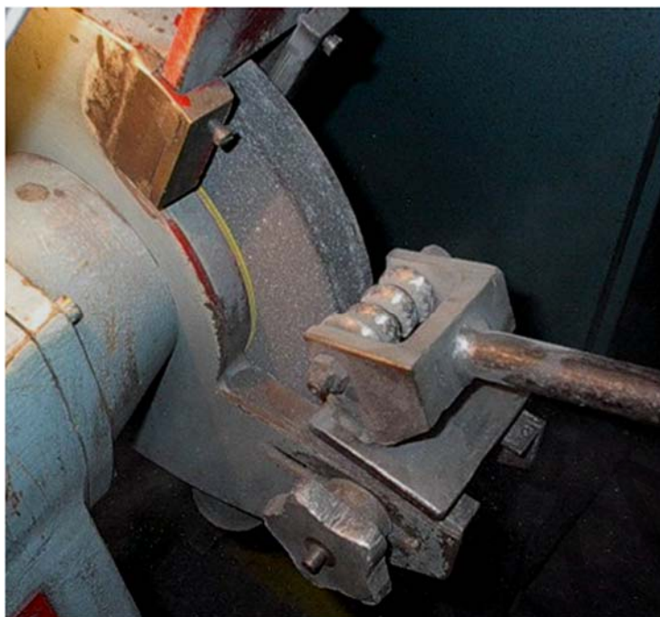
Korongszabályozás csillag szabályozóval (durva szabályozás)
