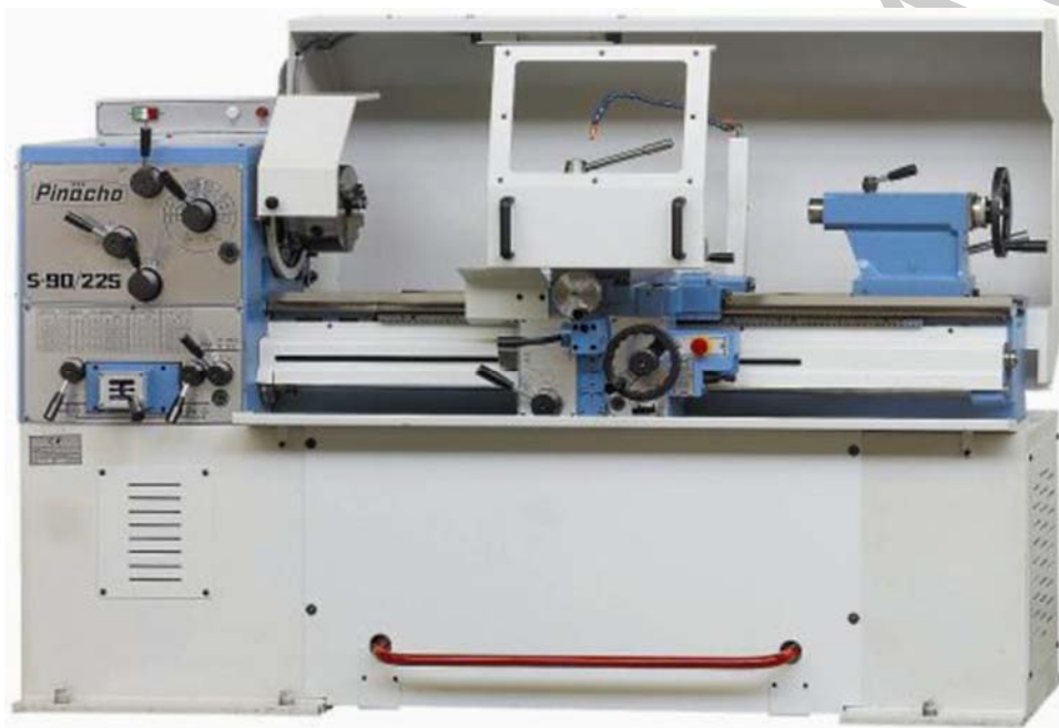
6. ábra. Esztergagép biztonsági berendezésekkel
