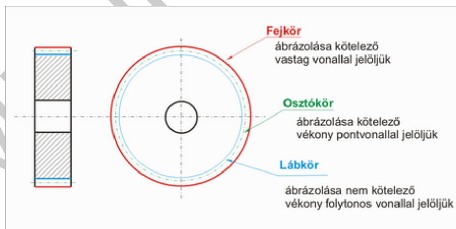
12. ábra. Fogaskerék ábrázolása
