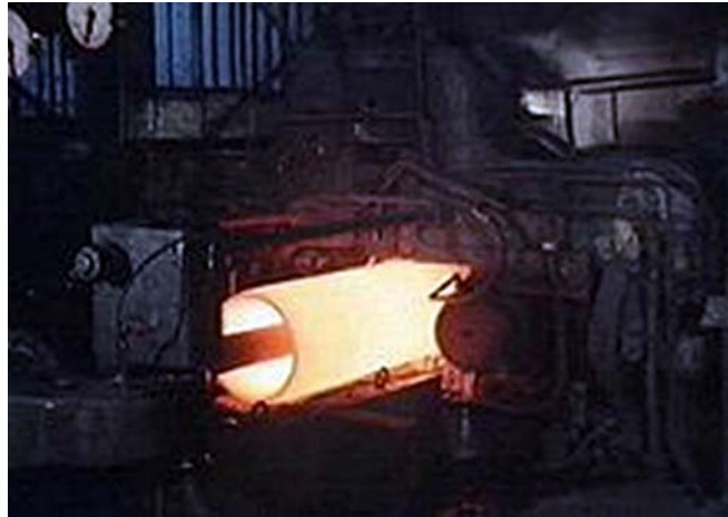
11. ábra. Lyukasztó ferdehengerek sorból kifutó cső 11
