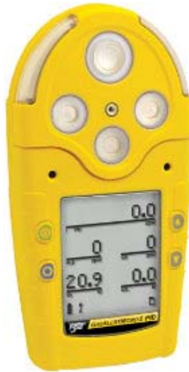
3. kép Korszerű, 4 csatornás gázkoncentráció mérő készülék 3
