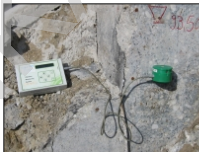
13. ábra Rezgémérő műszer és háromcsatornás geofon
