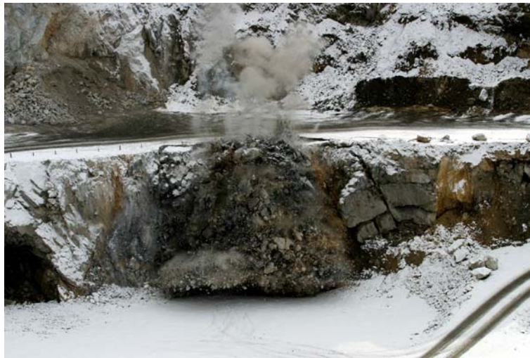
4. kép Jól érzékelhető repeszhatás körzet, ellenőrzött kőzetrobbantás alkalmával
