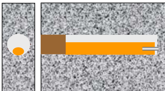
3. ábra Nem megfelelően kitöltött töltési ür (Légrés a robbanó töltet felett)
