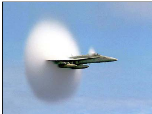
6. ábra Szuperszonikus vadászgép átlépi a hangsebességet, a hanghullámok feltorlódnak
