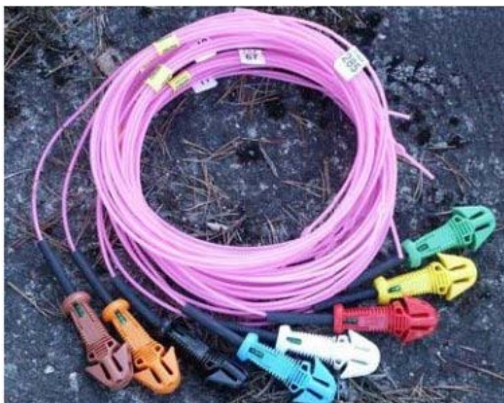
30. kép Külső késleltető elem sorozat szerelt NONEL vezetékkel
