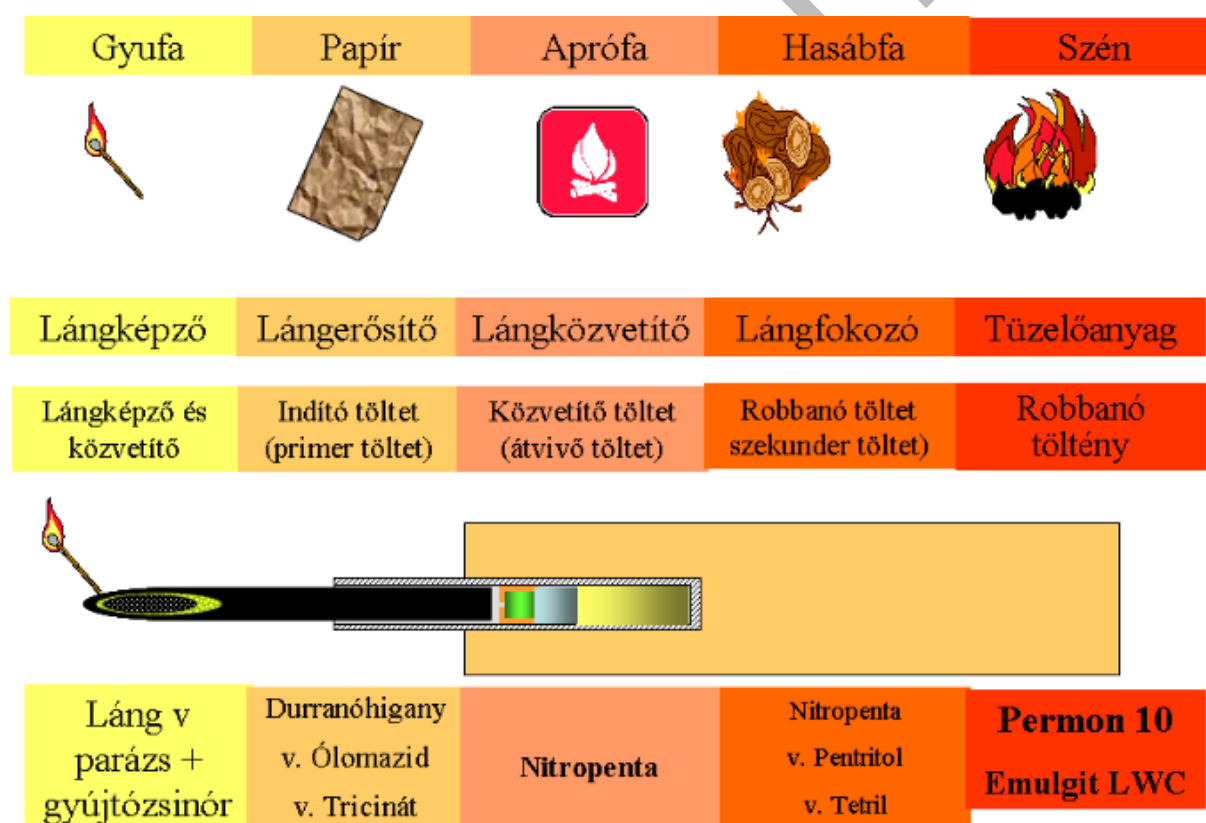
5. kép Gyújtási lánc elemei gyújtószinóros gyújtás esetén a tűzgyújtás analógiájával
