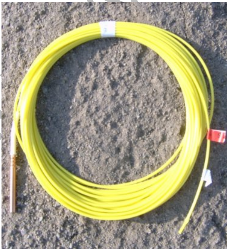
2. kép NONEL (Nem elektromos) rendszerű iniciálást közvetítő "robbanó zsinór" gyutaccsal
