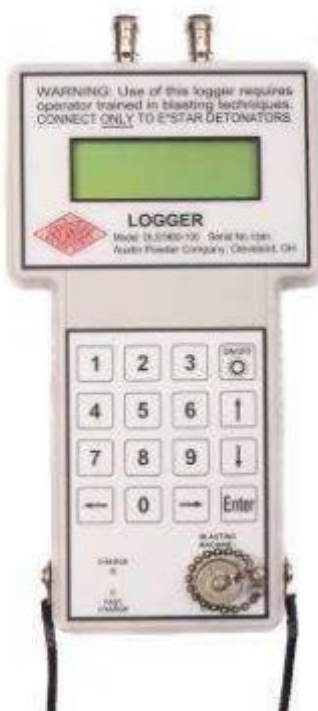
19. kép Az elektronikus gyutacsok programozására szolgáló berendezés (Logger)
