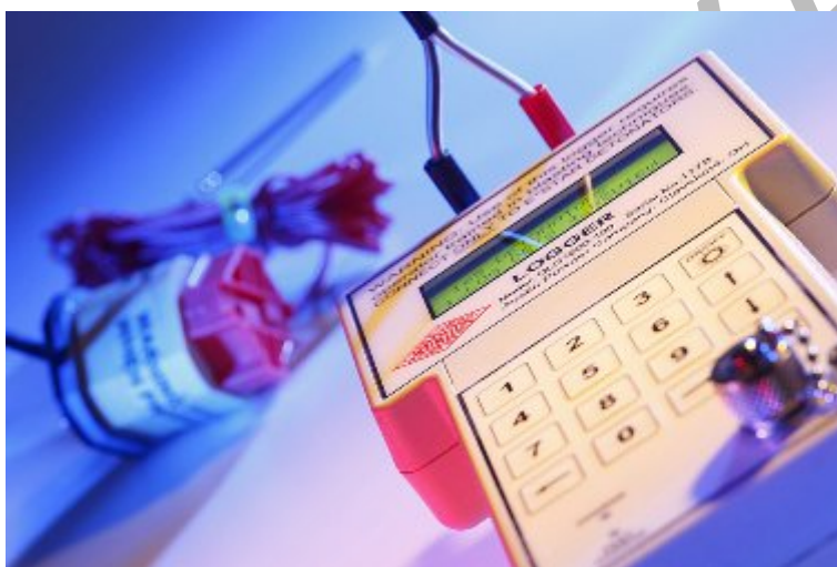
4. kép Egyenként szabályozható késleltetési idejű elektronikus gyutacsok és beszabályozó egység
