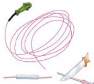
25. kép A toldó csőbe illesztett, merőlegesen vágott NONEL vezeték toldása
