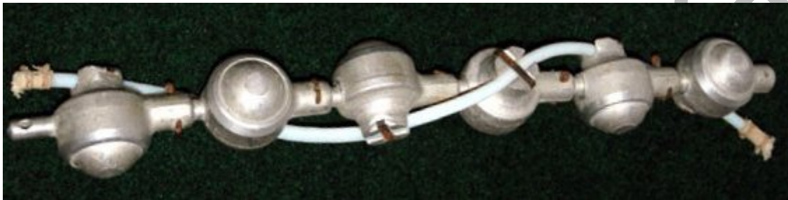
6. kép Robbanózsínórral összekötött perforátorok
