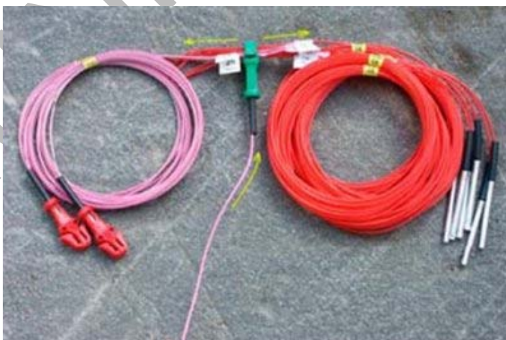
31. kép Külső késleltető elem (zöld) kapcsolása további külső késleltetőkhöz (piros, bal oldalt) és gyutacsokhoz piros színű NONEL vezetéken keresztül (jobb) az iniciálás irányával (sárga nyilak)
