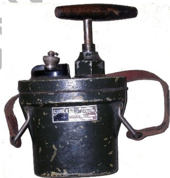
17. kép Dinamó-elektromos robbantógép (korszerűtlen)
