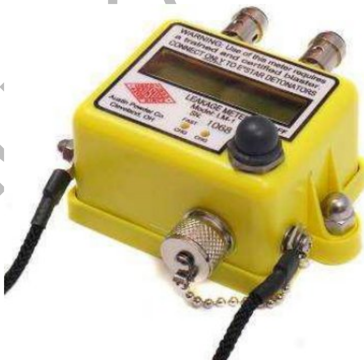
20. kép Elektronikus gyutacs ellenőrző teszter
