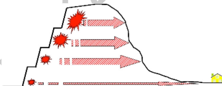
13. ábra. A robbantással azonos magasságban és árnyékoló zóna nélkül álló védendő létesítmények érdekében csökkentett robbantó töltet alkalmazásával mérsékelhető a szeizmikus terhelés
