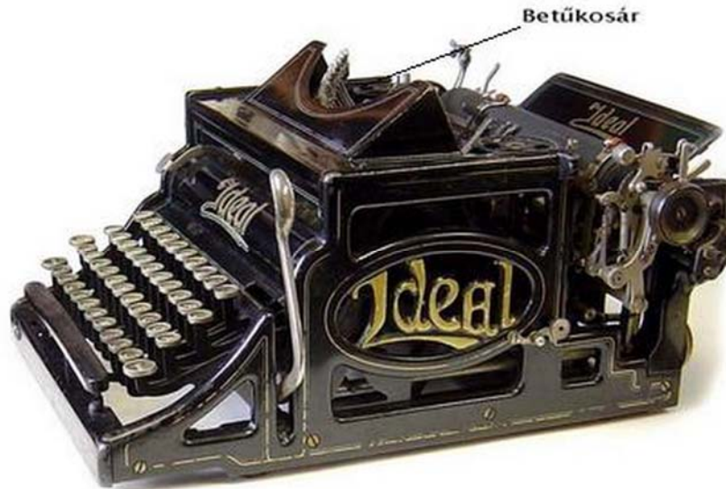
12. ábra. Régi mechanikus írógép, amelyen jól látható a betűkosár helye 9
