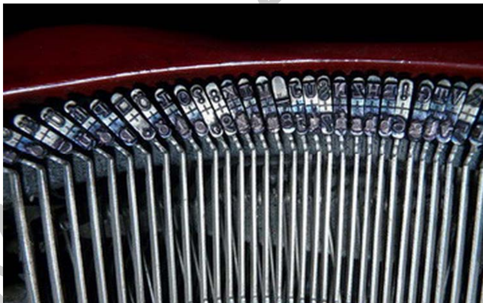
13. ábra. Írógép betűkosara közelről. A betűkarok végén helyezkednek el a betűfejek. 10
