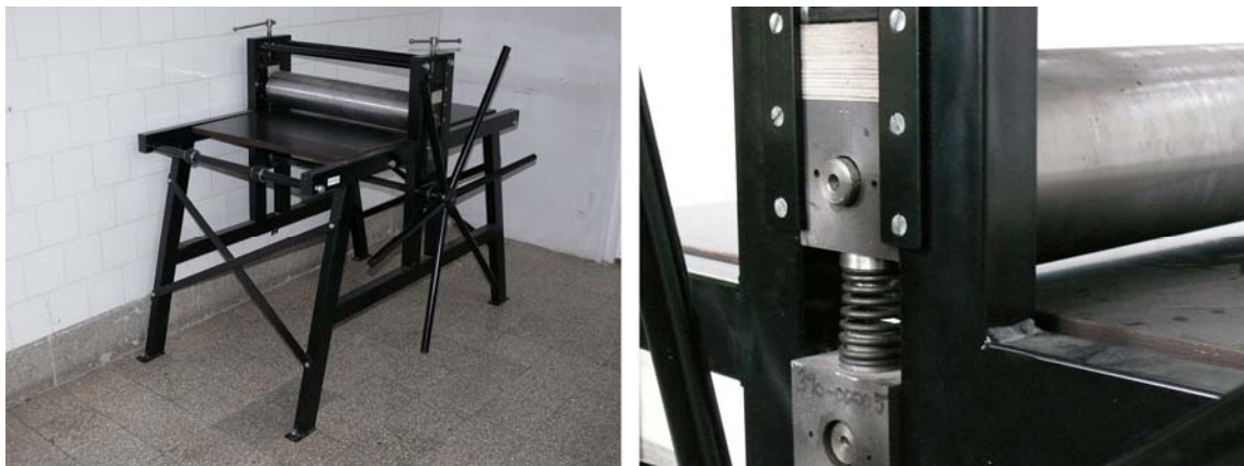
3. ábra Egy csillagkaros rézkarcnyomó prés. Jól látható a nyomóerőt szabályozó mechanika, amit minden nyomólemeznél pontosan be kell állítani
