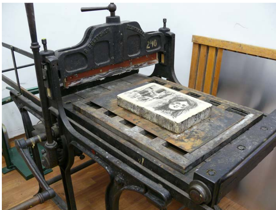
4. ábra Jellegzetes litográf sajtó. Egy-egy ilyen szerkezet akár 100–150 éves is lehet, de ez mit sem von le használati értékéből, sőt...
