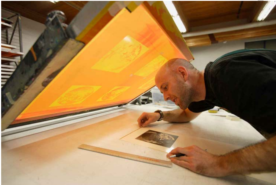
27. ábra. A nyomópapír beillesztése 20
