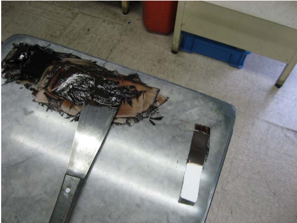
12. ábra. Litográf festék előkészítése 9
