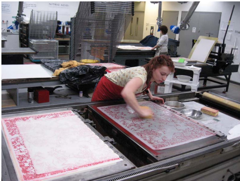
19. ábra. Alumíniumlemez nedvesítése festékezés közben 12
