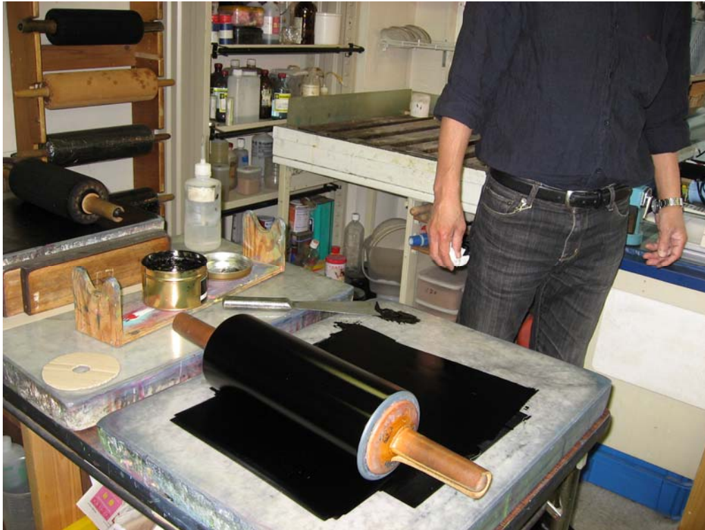
13. ábra. Litográf festék szétterítése festékező hengerrel 10
