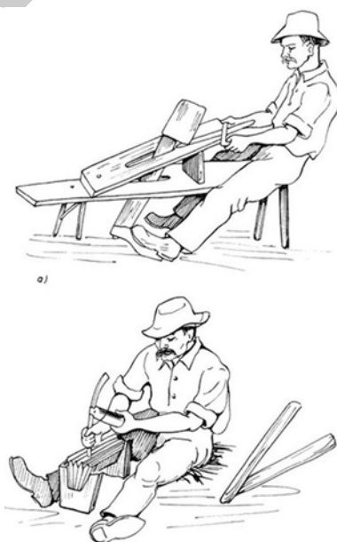
5. ábra Fa megmunkálása vonópadon, zsindelekészítés
