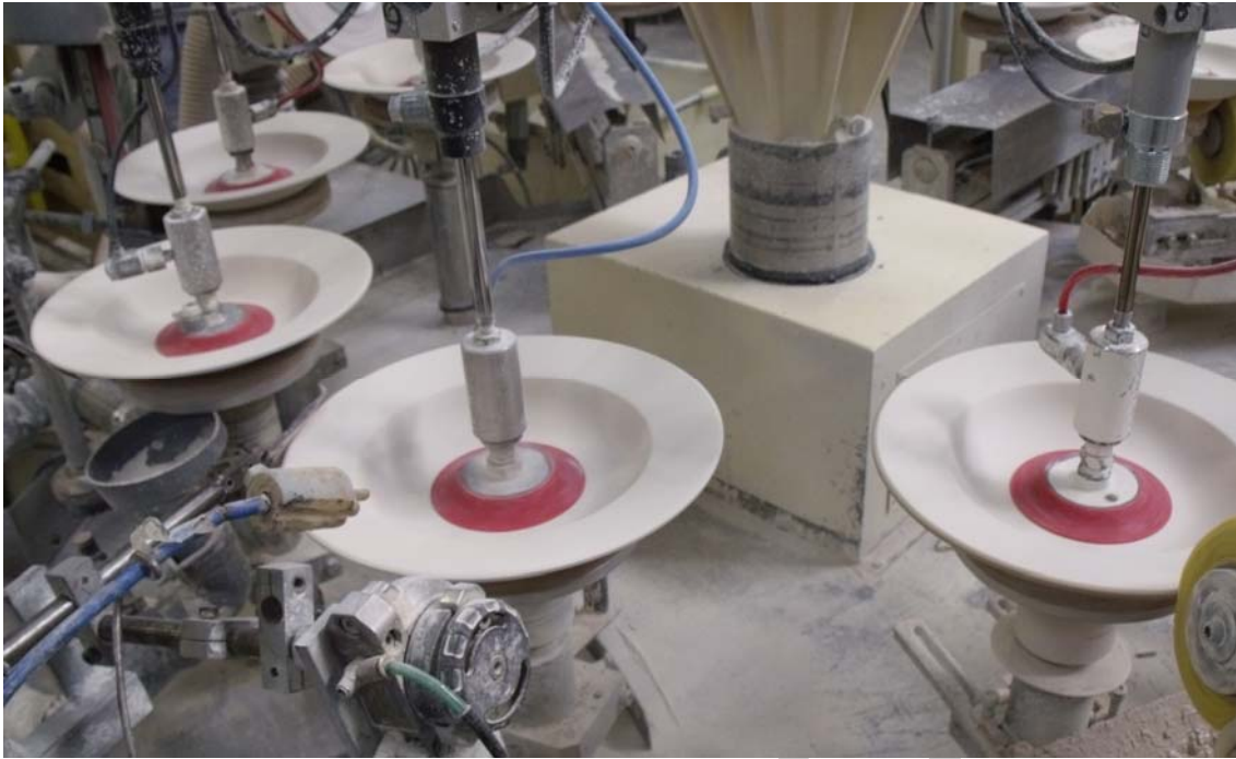
7. ábra. Izosztatikus présgépből kikerülő termékeket robot tisztítja 7
