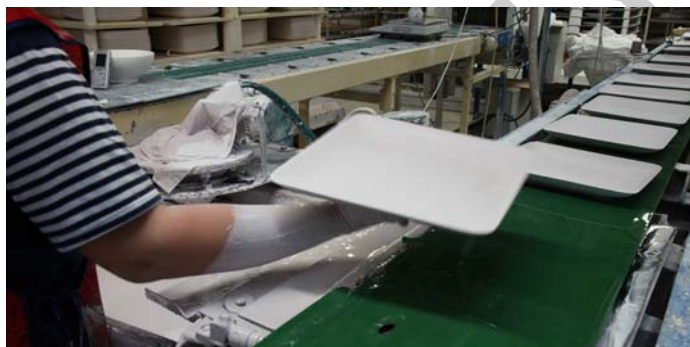
4. ábra. Merítéssel/mártással történő mázazás 4
