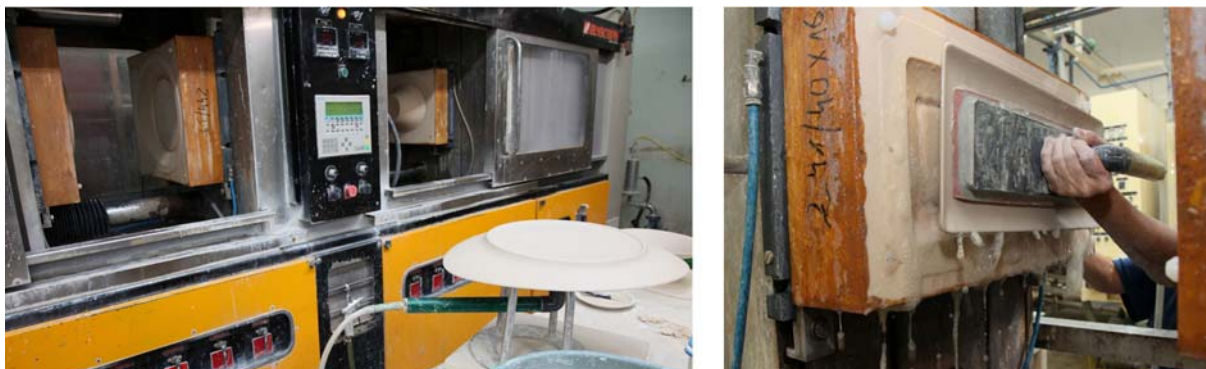
10. ábra. Nyomás alatti öntésre szolgáló gép és a nyerstermék kiemelése 10
