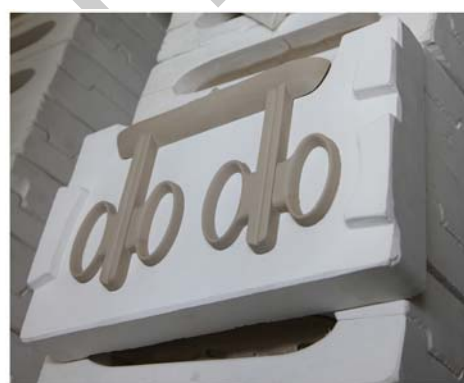
2. ábra Nyitott és zárt öntéssel készülő termékek 2
