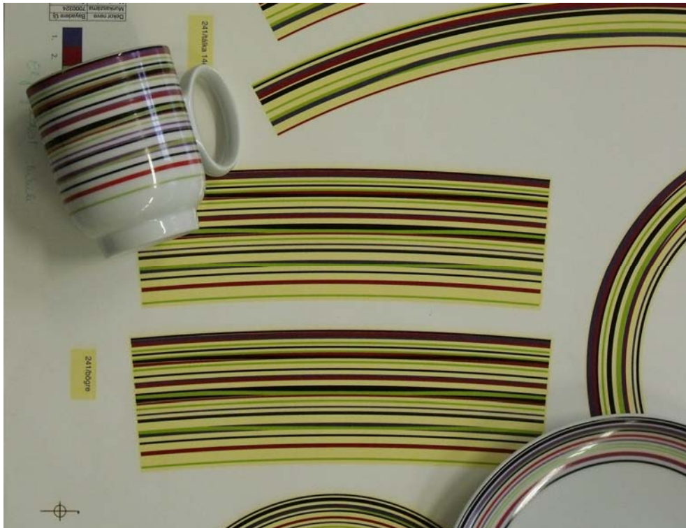
14. ábra. Lakkozott matrica ív és a késztermék 14
