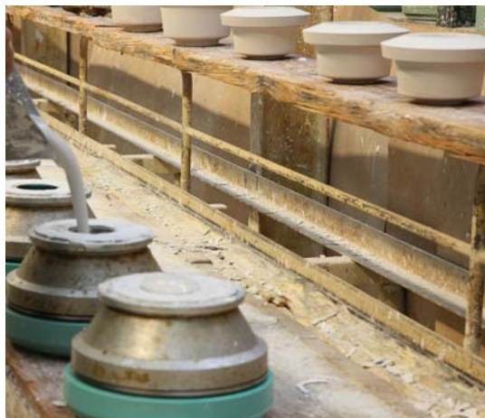
1. ábra. Műanyag és fém kombinációjából összeállított berendezéssel sokszorosítják a gipsz munkaformát a beformázáshoz az Alföldi Porcelán Edénygyár Zrt.-ben 1
