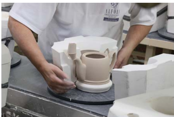
2. ábra Nyitott és zárt öntéssel készülő termékek 2
