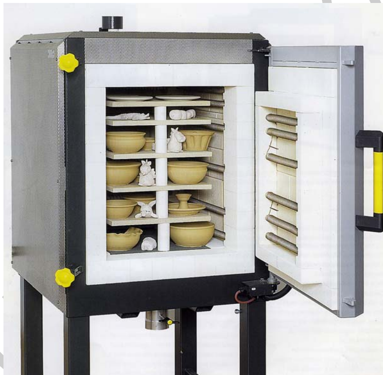
1. ábra. Szakaszos üzemű, villamos fűtésű kemence
