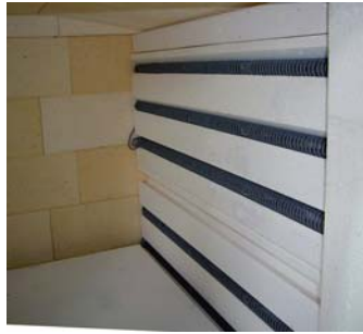
2. ábra. Kanthal huzalok égetőkemence oldalfalában
