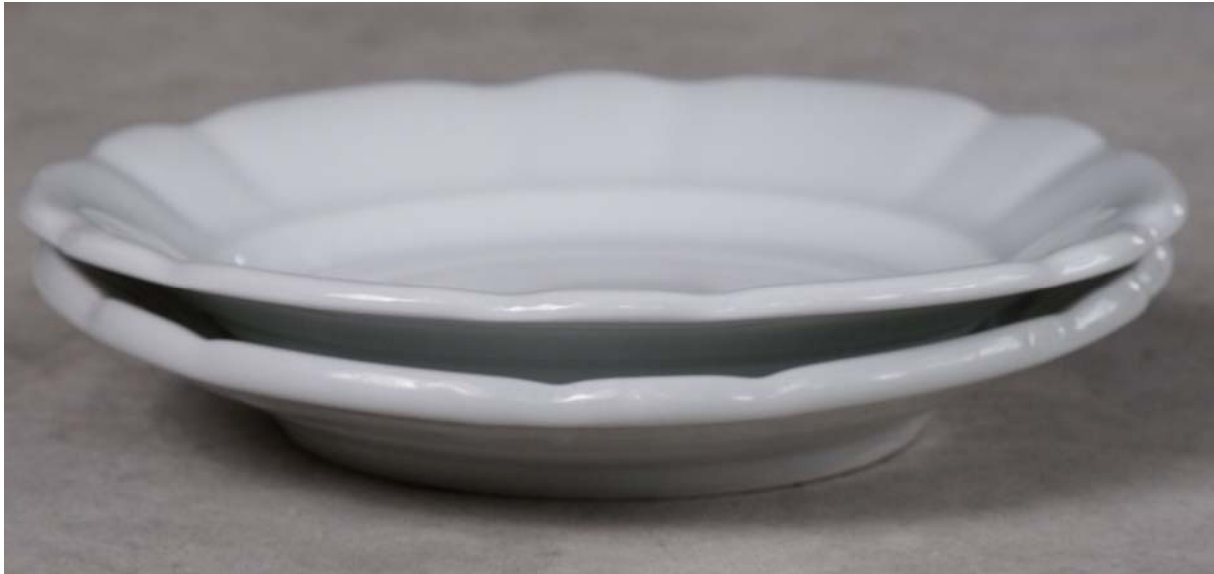
2. ábra. A formázó fémsablon hibás beállításából adódó falvastagság-különbség a készterméken 2
