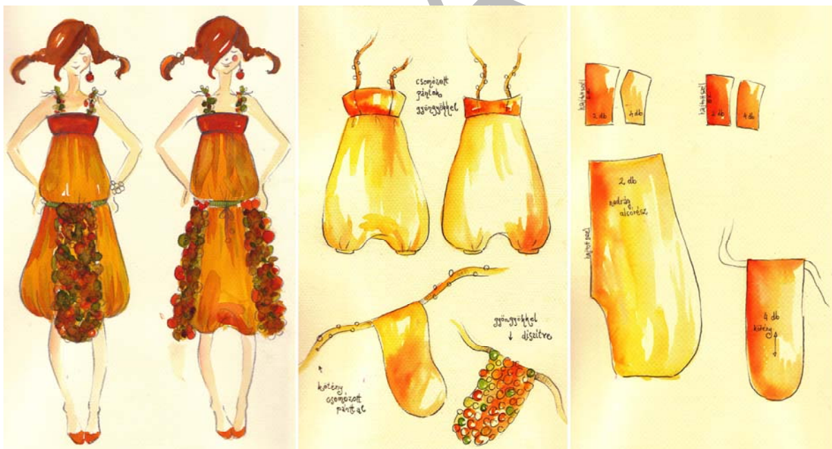
42. ábra. Női modell divatgrafikája, műhelyrajza, méretarányosan lekicsinyített szabásmintája
