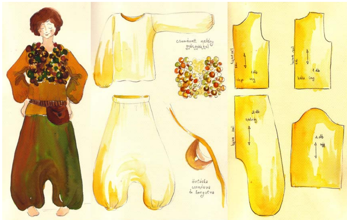
43. ábra. Férfi modell divatgrafikája, műhelyrajza, méretarányosan lekicsinyített szabásmintája
