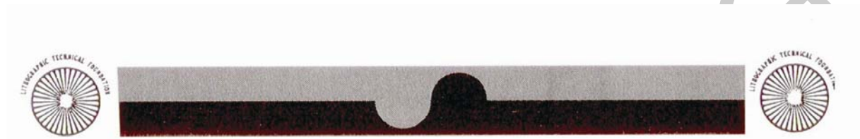
5. ábra. A nyomólemez-másolás minőségének ellenőrzésére szolgáló, egyszerű skála
