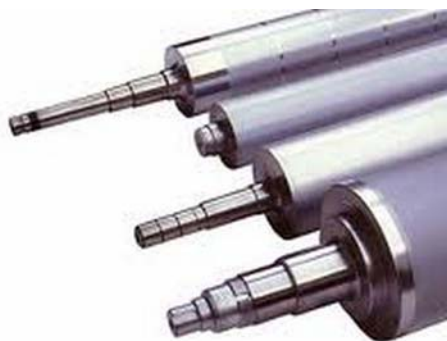
7. ábra. Krómozott raszterhengerek 7
