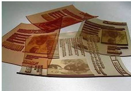
2. ábra. Fotopolimer nyomóformák 2
