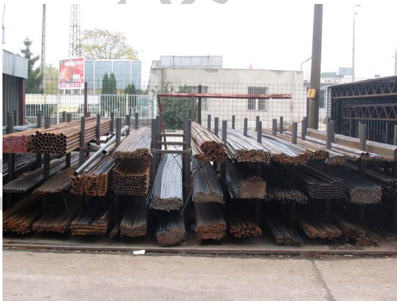
5. ábra Betonacéllok és csövek állványon 5
