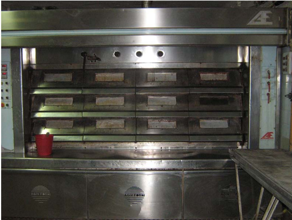
2. ábra. Alsóventilátoros kiskemence
