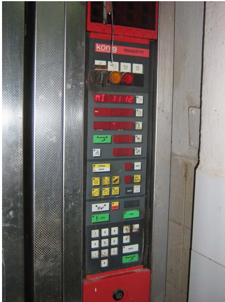
4. ábra. Forgókocsis kemence szabályozó egysége
