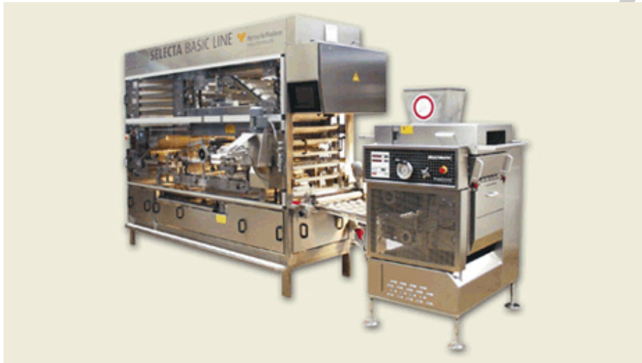
16. ábra Automata folyamatos zsemlegyártó gépsor
