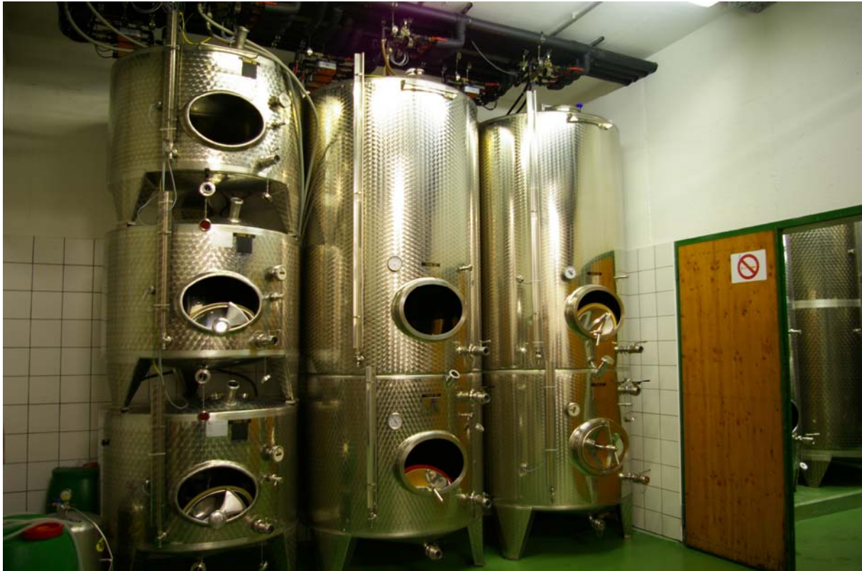
5. ábra. Korszerű saválló acélból készült erjesztő berendezések
