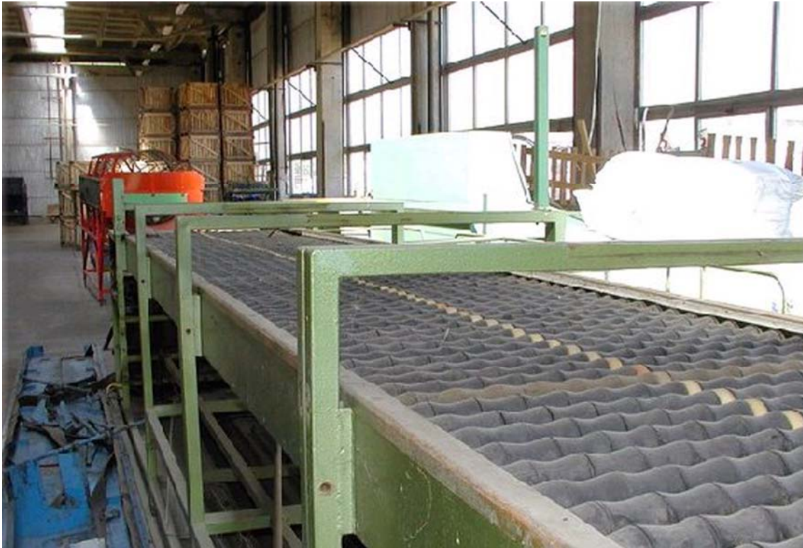
9. ábra. Dió osztályozó gép 9
