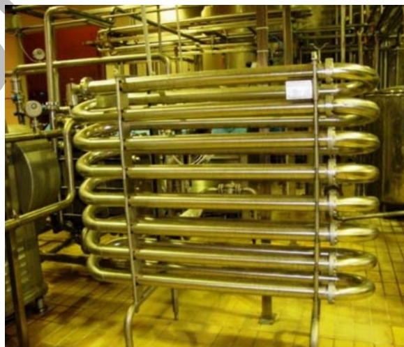
4. ábra. Lemezpasztórhöz kapcsolt csöves hőntartó
