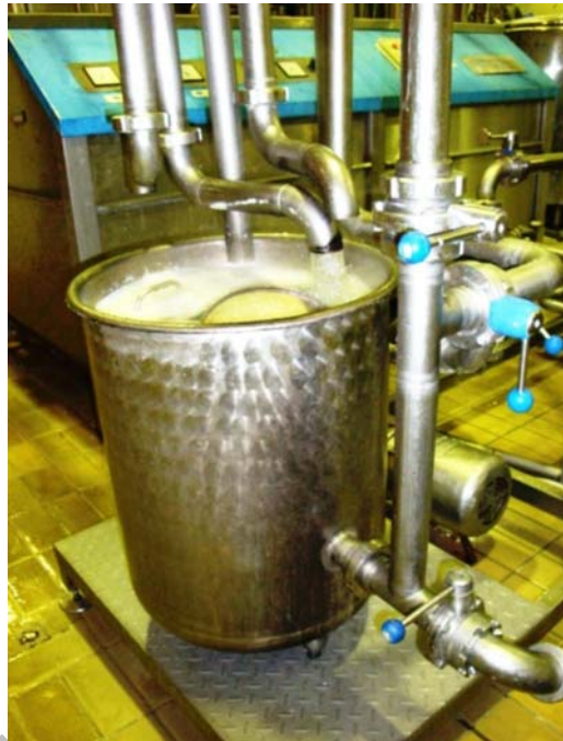
3. ábra. Lemezpasztőr köráramoltatásos tisztogatása az úszós előtétartályból
