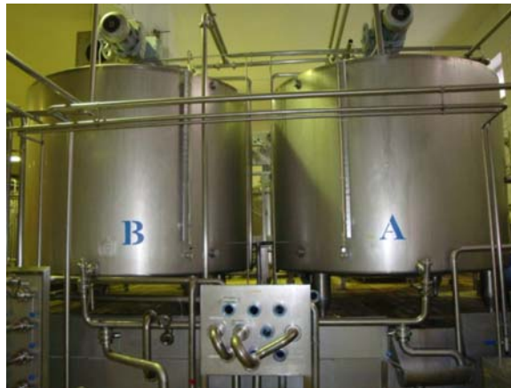
3. ábra. Tankok töltése és ürítése panel (kapcsolótábla) segítségével
