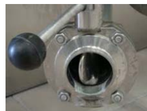
3. és 4. ábra. Pillangószelepek zárt és nyitott állapotban
