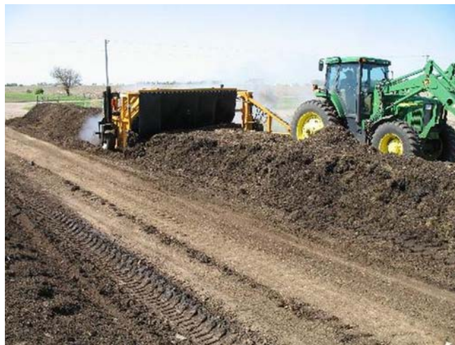
14. ábra. Szerves trágya nyitott rendszerű forgatásos komposztálása, Wildcat PTS 612 PTO vontatott forgatóeszköz 25
