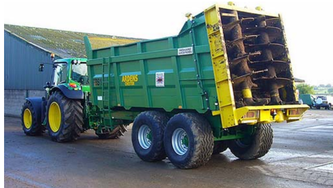
10. ábra. FBS12 függőleges tengelyrendezésű szervestrágya-szóró 17
