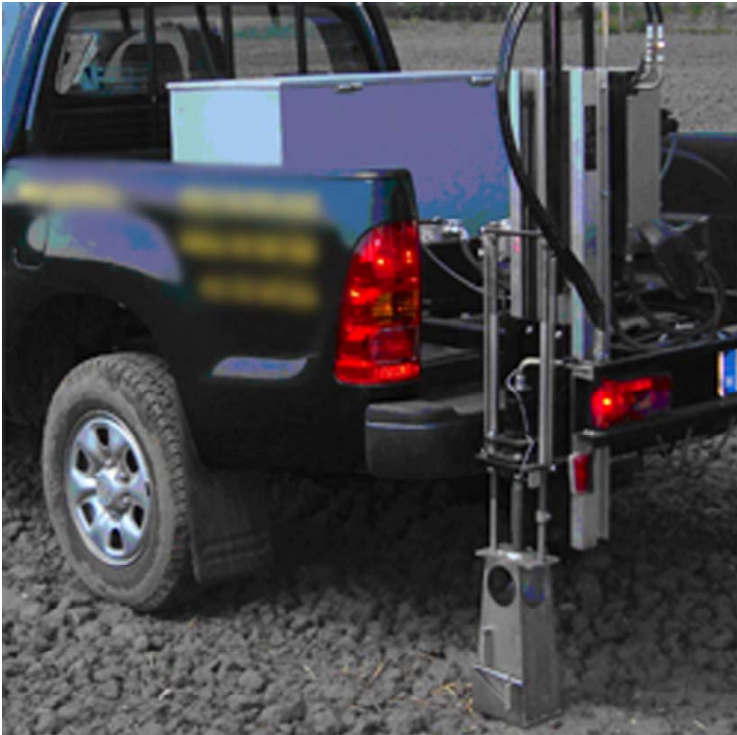
10. ábra. Mobil gépi talajmintavétel
