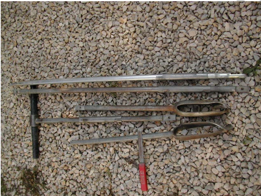
8. ábra. Kézi talajmintavevő eszközök
