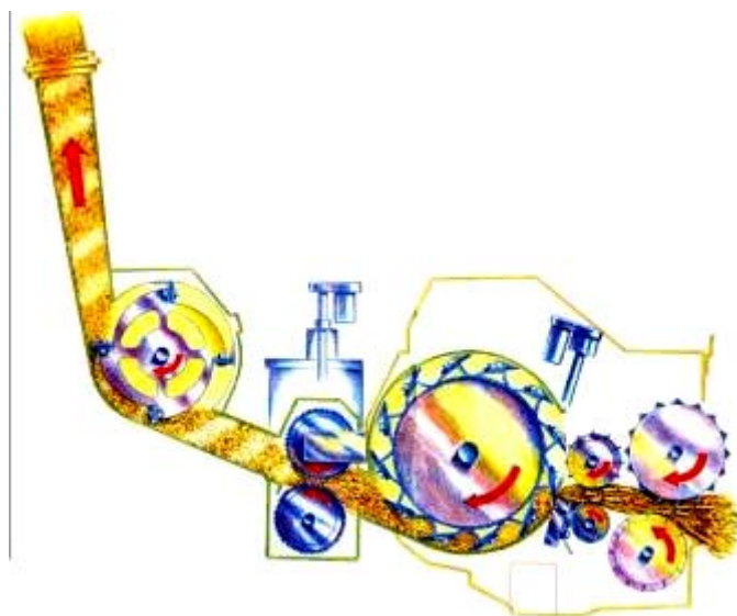
6. ábra Dobrendszerű segédventillátoros szecskázószerkezet
