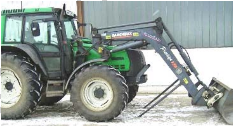
14. ábra Gémszerkezet összekapcsolása
