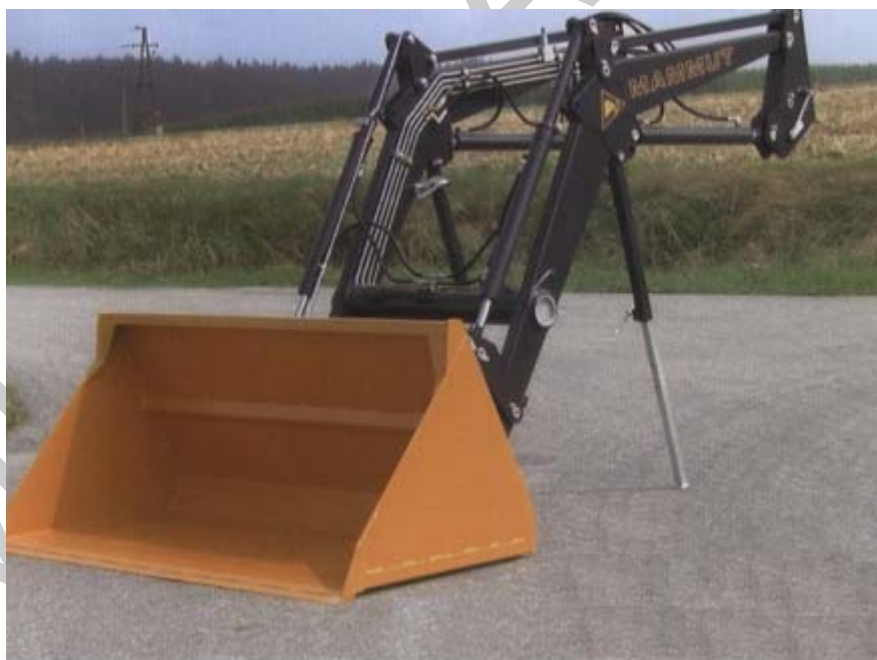
17. ábra Lekapcsolt gémszerkezet kanállal
