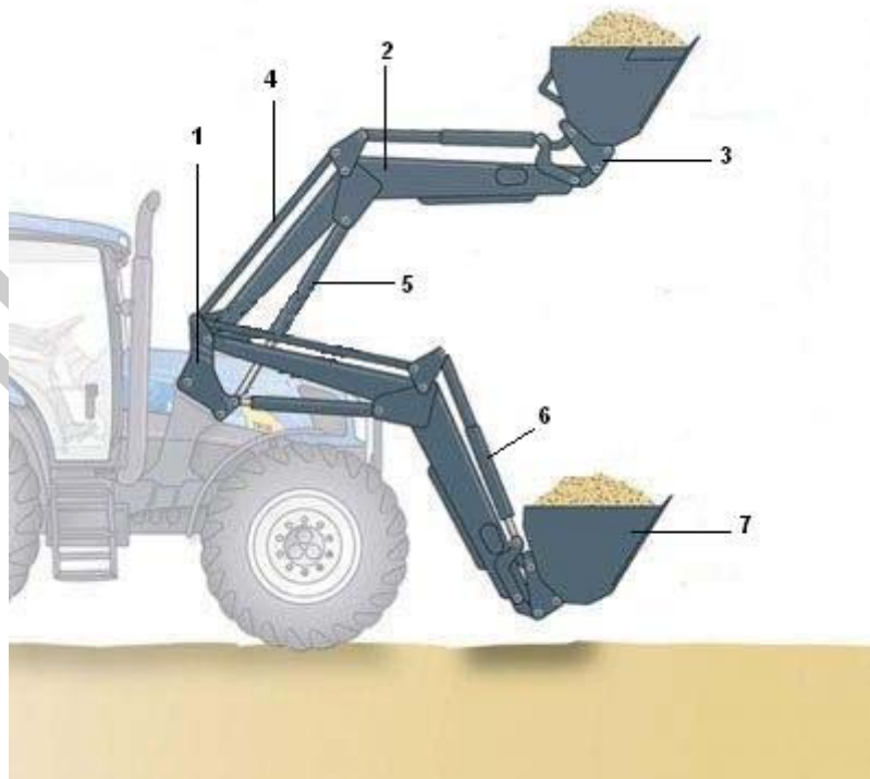
2. ábra Homlokrakodó gép – szerkezeti felépítése
