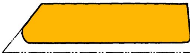
33. ábra A szántóvas kopása
