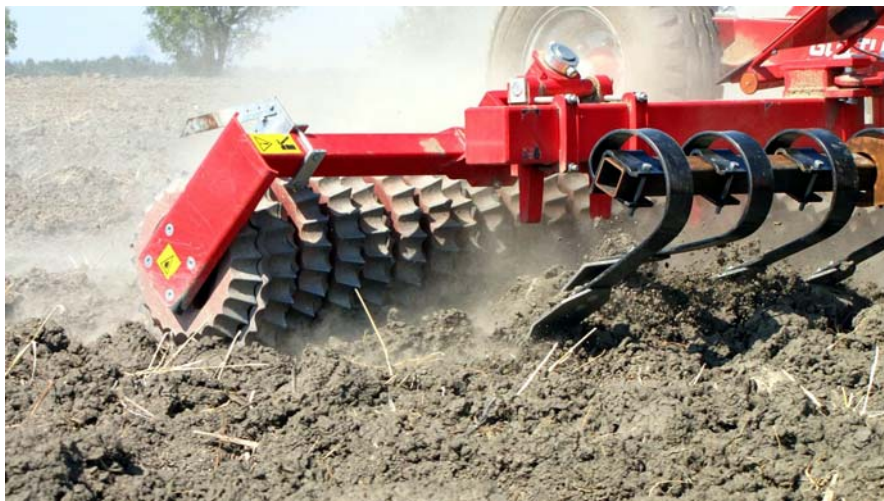
5. ábra Lazító és henger együttes alkalmazása
