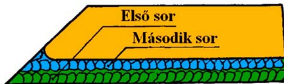
43. ábra Hegesztéssel felújított szántóvas
