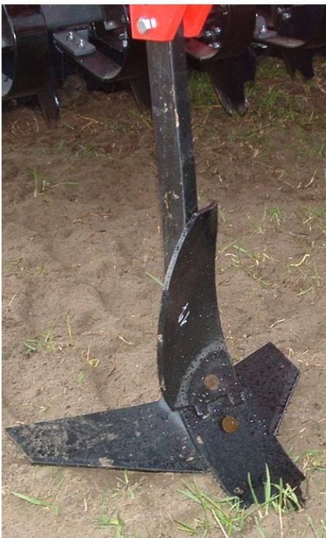
71. ábra Merev lazítószerszám felfüggesztése
