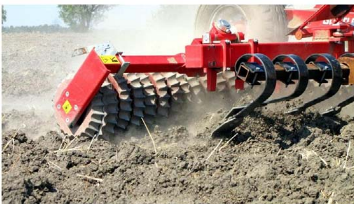
62. ábra Güttler henger kialakítása és munkája
