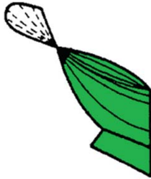
22. ábra Csavart kormánylemez
