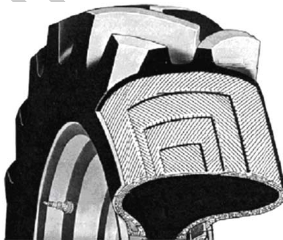
17. ábra Diagonál abroncs szerkezete
