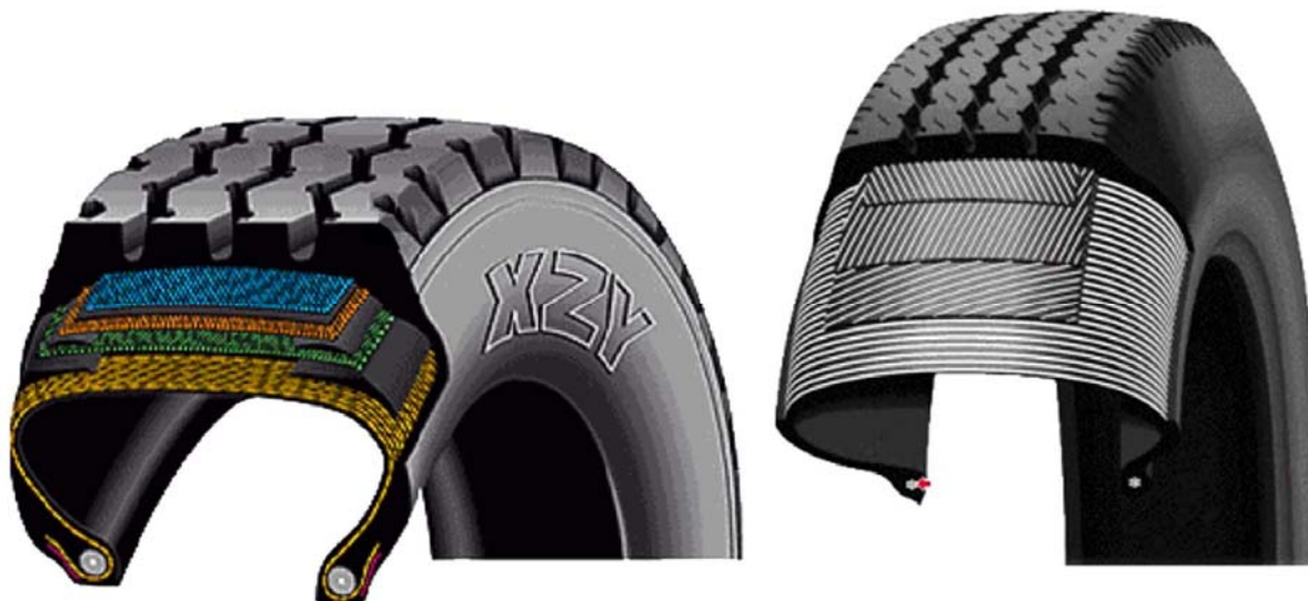
18. ábra Radiál gumiabroncsok szerkezete
