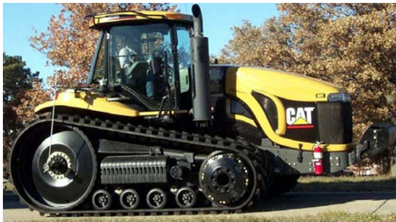
44. ábra Megnövelt hátsó hajtókerék átmérő
