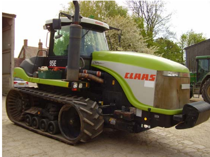
7. ábra Gumihevederes korszerű traktor
