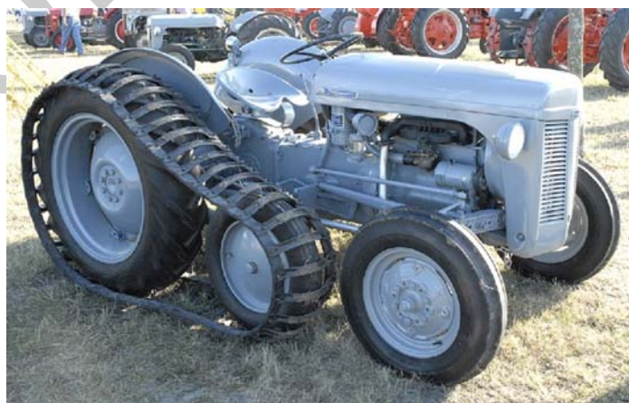
39. ábra Átmeneti megoldás a lánctalp és a hevederes kialakítás között
