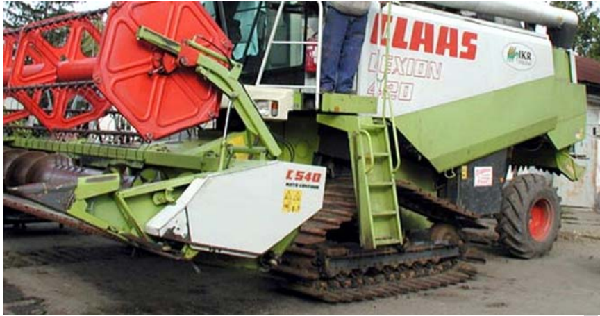
28. ábra Féllánctalpas járószerkezet
