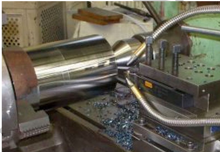
19. ábra. Hosszesztergáláskor új fogás kezdődik
