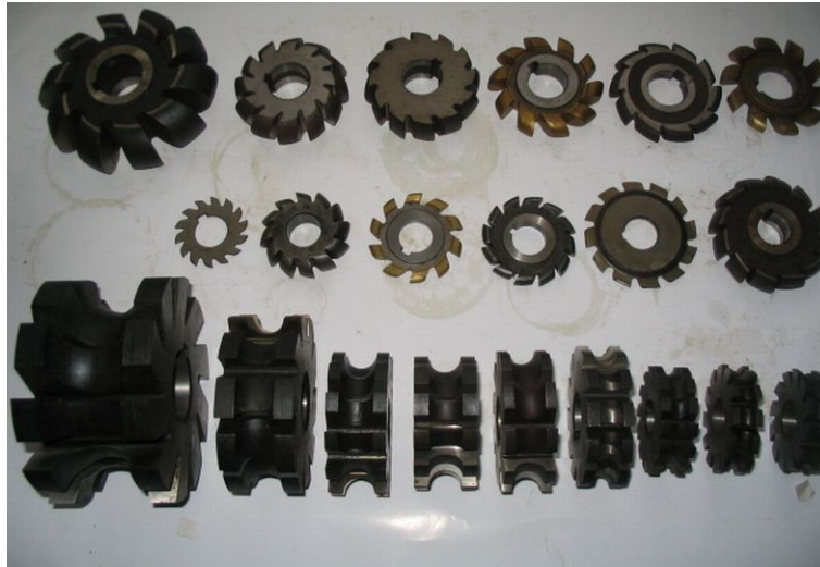
7. ábra. Szabályos többélű maró szerszámok
