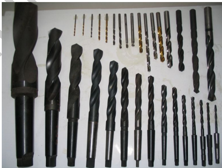
6. ábra. Kúpos szárú kétélű csigafúrók
