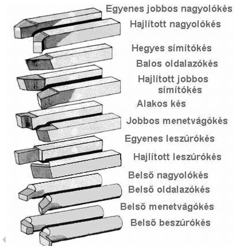
15. ábra. Esztergakések változatai
