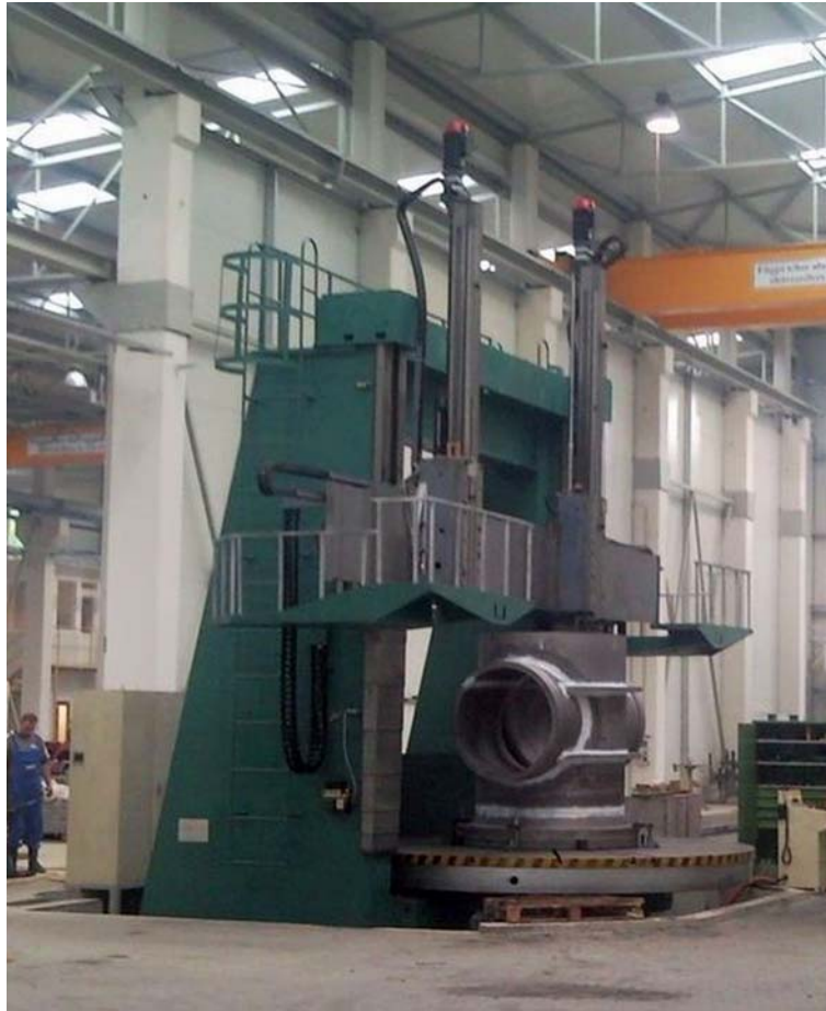
18. ábra. Modern karusszel eszterga 4500mm-es asztallal
