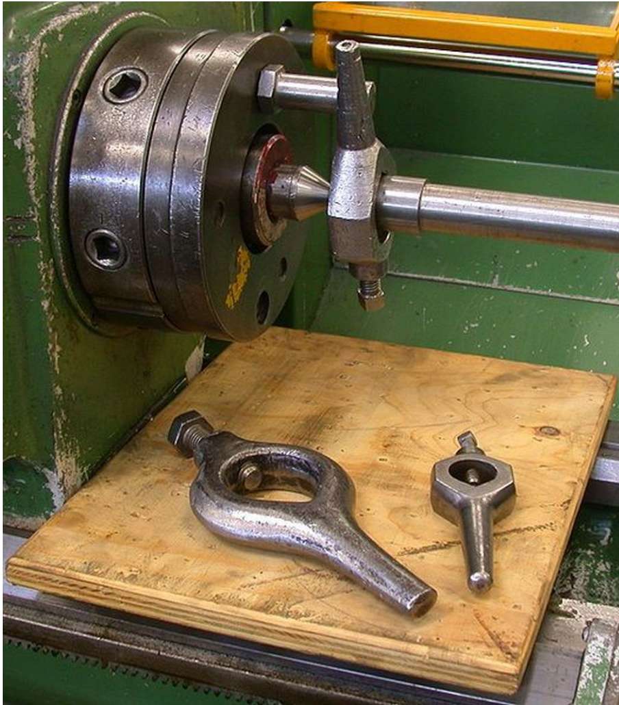
32. ábra. Munkadarab meghajtás esztergaszívvel
