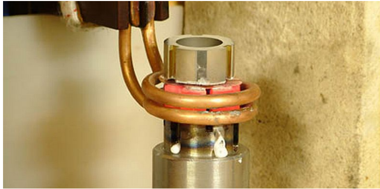
28. ábra: Indukciósan felhevített munkadarab
