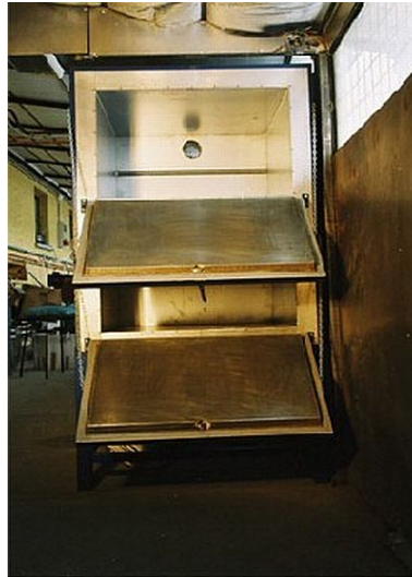
22. ábra: Elektromos hőkezelő kemence forrasztási feladatra is megfelel
